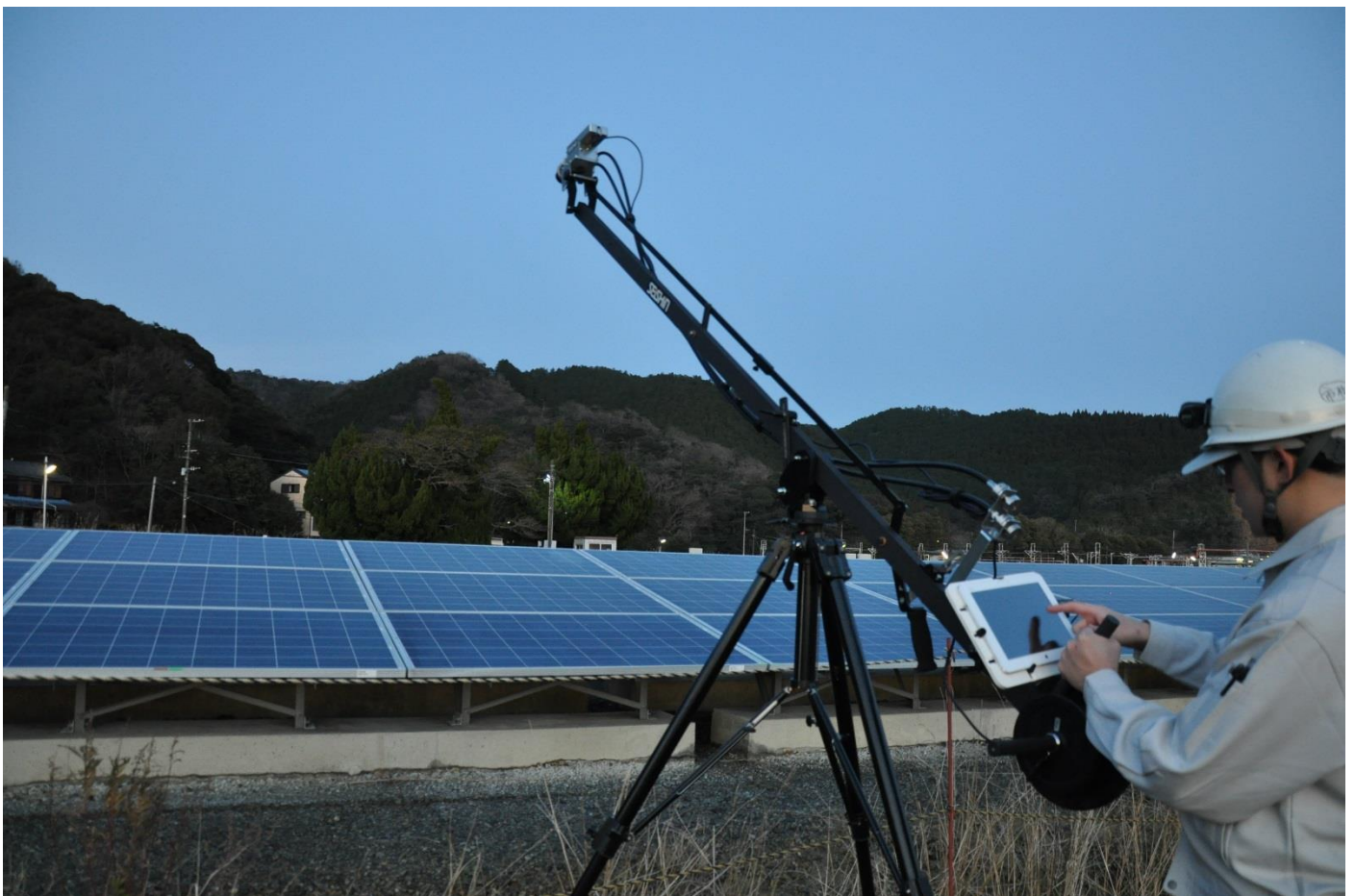
クレーン上にセットされたカメラ
